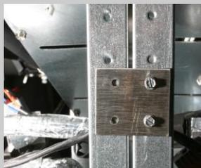
薄片金属拉环可将炉柜牢牢固定在一起。
