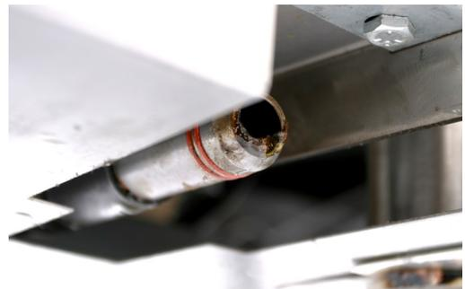
5 确保凸形吸管上的 O 形圈完好无损。
