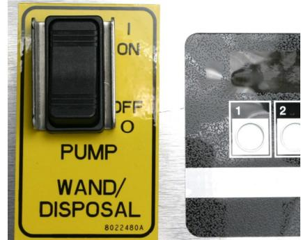
软管导入炸锅中后，使用安装在前侧的开关打开过滤泵。
