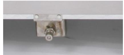
将处理油管软管连接到炸炉前侧的快速断开装置。
