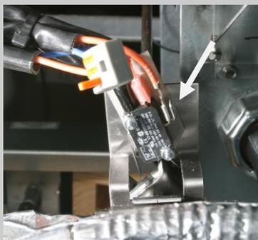
位于 wego 连接器左上方的插销用于指示来自相邻炉柜接线的布置。排放开关上安装的附加端子（见箭头）用于连接排放安全电路。
